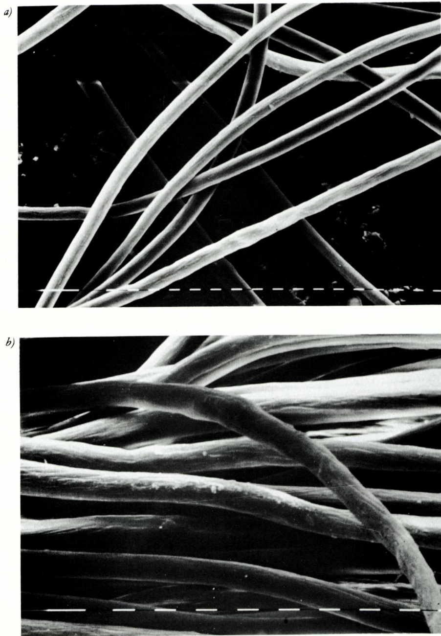
Figura 6. 6a) Fibres ensimades sense defectes (x 400). Marques: 10 \mu\text{m} . 6b) Fibres ensimades sense defectes (x 700). Marques: 10 \mu\text{m} .
